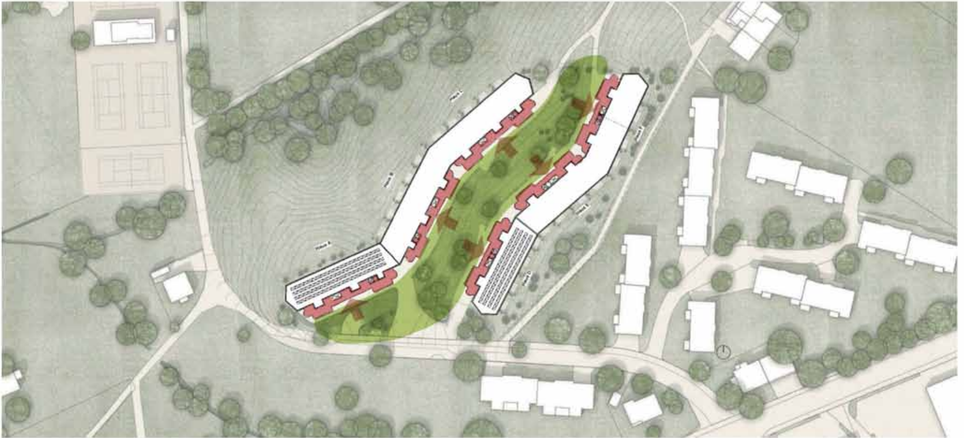
Zwei geknickte Zeilen folgen den Höhenlinien, spannen einen gemeinsamen, zusammenhängenden Binnenraum auf, Adressbildung über Verandaschicht ab Binnenraum
