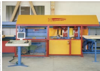
Vollautomatische Abbundmaschine 2009: Firma Hundegger, K2i
